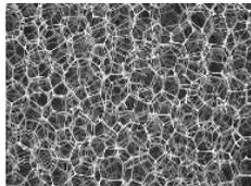
Für unsere Akustik-Absorber setzen wir Melaminschaum Basotect® oder Smart Acoustic Woll 40 ein. Dessen offenzellige Oberfläche gewährleistet, dass Schallwellen nicht als Hall reflektiert werden, sondern ungehindert in die Zellstruktur eindringen können. In der Zellstruktur wird die Schallenergie abgebaut.
