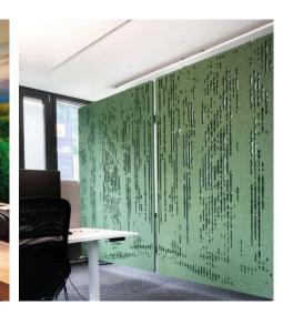
Die Akustikplatte besteht aus recycelbaren Polyesterfasern mit kompakter Oberfläche. Durch ein innovatives Spezialverfahren erhält das PET-Board seine einzigartige Eigenstabilität und benötigt weder einen Rahmen noch einen Überzug. Die Akustikpanels sind allergikerfreundlich, da sie frei von Glaswolle, Asbest, Formaldehyd oder chemischen Bindemitteln sind und auch keine Feinstaubpartikel, Milben oder Fusseln verursachen
